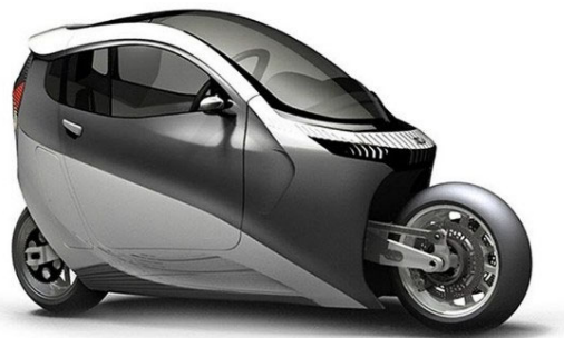
Figure 2 – Le Lit Motors AEV (véhicule électrique gyrostabilisé)
