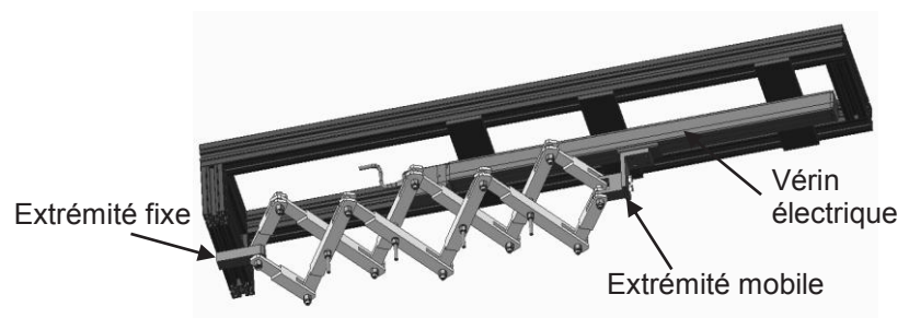
Figure 10 - Vérin électrique d'ajustement de l'entraxe du pantographe
