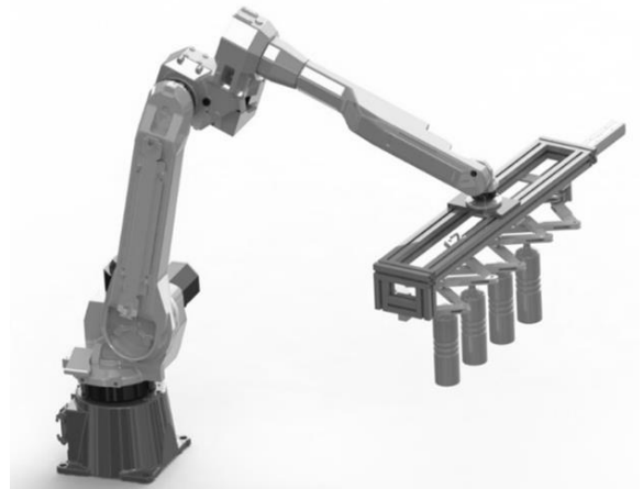
Figure 8 - Robot de manutention du pantographe
