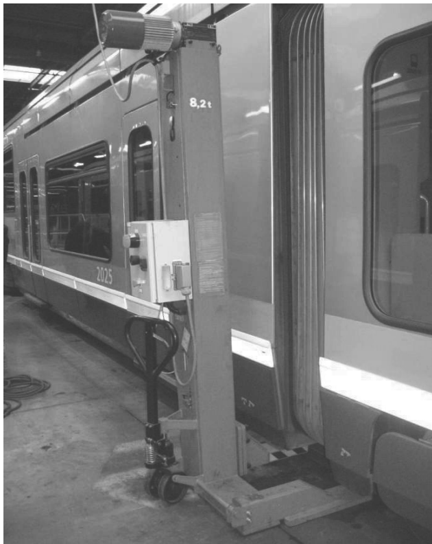
Photo 3 : Mise en place d'une colonne
